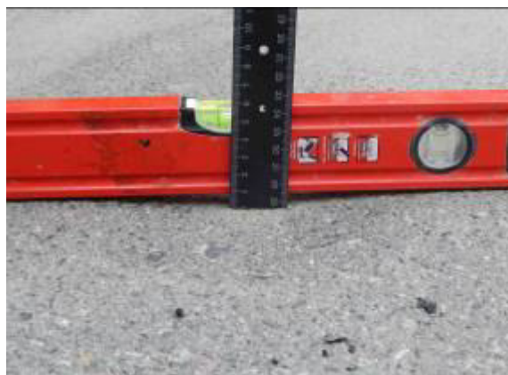
Рисунок 6 – Лунка на покритті, що утворилася після серії ударних навантажень
