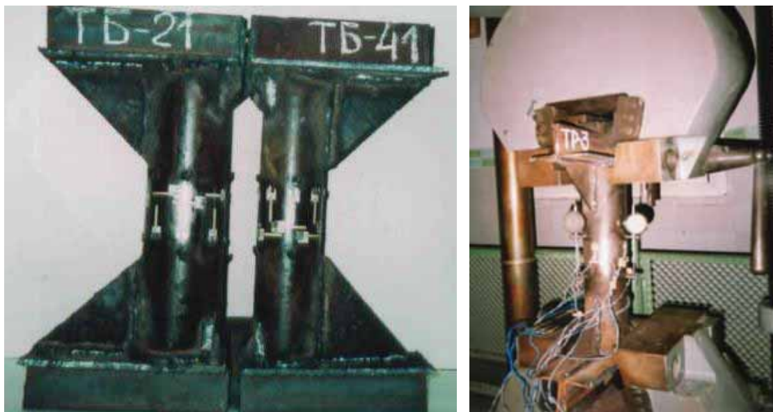
Рис. 2 – Загальний вигляд зразків, прийнятих до випробування, з наклеєними електротензорезисторами та під час випробування на розривній машині УВМ-100
