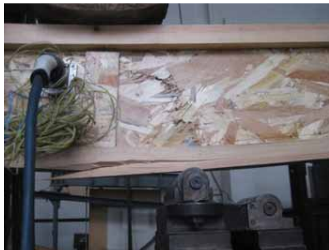
Рис. 8 – Характер руйнування дерев'яної балки
