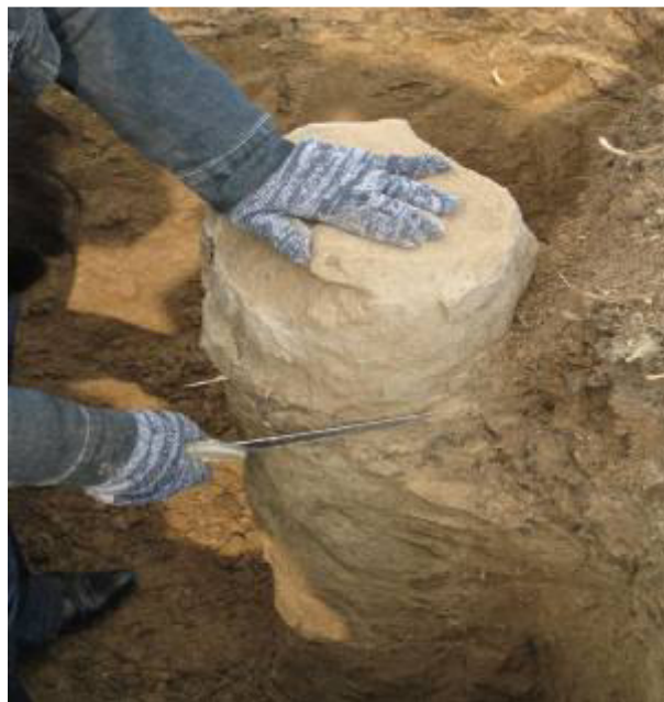
Рисунок 5 – Ґрунтоцементний елемент діаметром 200 мм у масиві ґрунту
