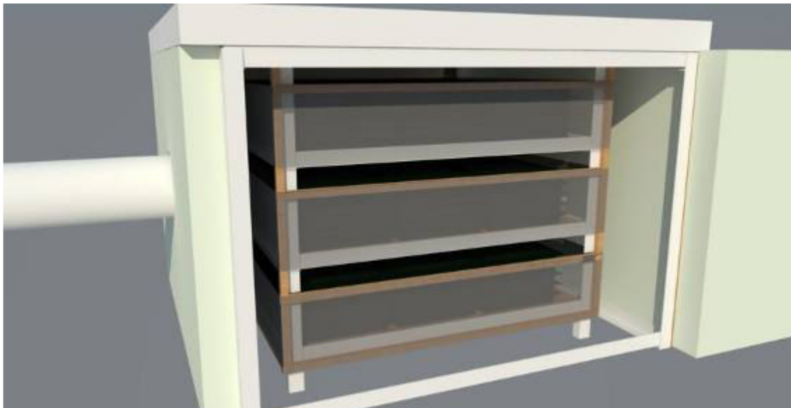
Рис. 2. Другий варіант конструкції камери для теплової обробки нагрітим повітрям бетонних тротуарних плиток
