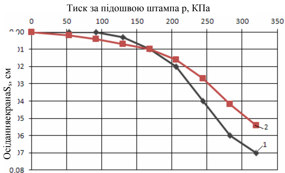
Рис. 7. Графік осідань екрана від дії навантаження на штамп: 1 – експеримент; 2 – моделювання
