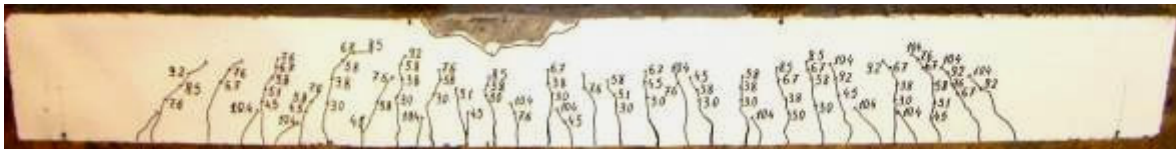
Рис. 2. Характер руйнування балок
