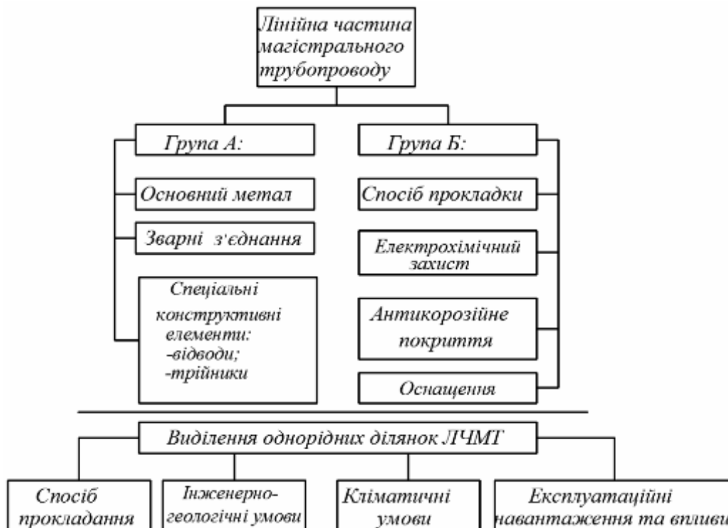
Рис. 2. Виділення однорідних ділянок лінійних частин магістральних трубопроводів
