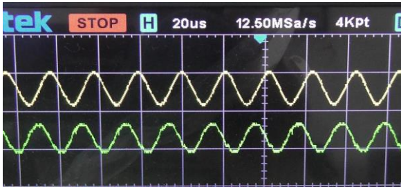
Рис. 3. Сигнали з виходу генератора ультразвуку і на виході приймача ультразвуку (верхній сигнал – сигнал передавача, нижній сигнал – вихід приймача) при відсутності об'єкта дослідження
