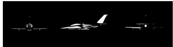
Рис. 14. Зразок декількох отриманих ракурсів ЛА (3D модель літака Л-39 без урахування радіопрозорості носового обтікача та кабіни)
