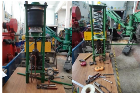
Рис. 5. Стенд для перевірки жорсткості пружних елементів
