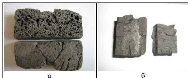
Рис. 4. Зображення фрагментів ділянок зон теплоізолювання у складних за формою конструкціях, проведених з заповненням робочої зони фрагментованими елементами і наступним термообробленням у розбірному оснащенні різної складності:
