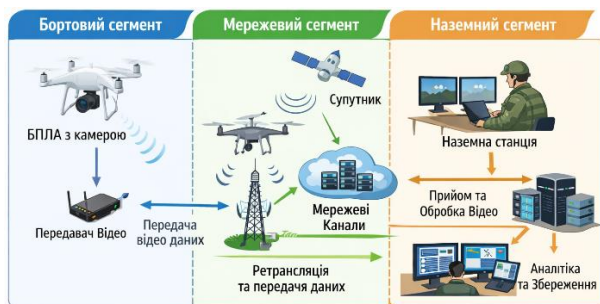
Рис. 1. Передавання відеоданих у комп'ютерній мережі БПЛА як взаємодія бортового, мережевого та наземного сегментів
