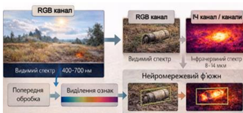
Рис. 5. Схема об'єднання RGB та IR зображень
