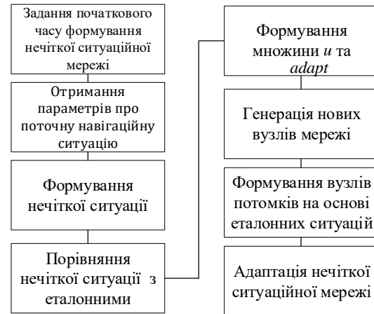
Рис. 4. Метод оцінки та прогнозування навігаційної ситуації під час руху судна на основі нечіткої ситуаційної мережі (джерело: розроблено автором)
