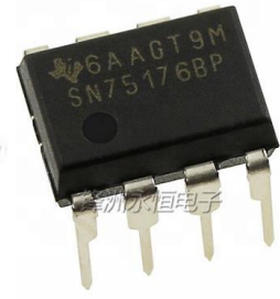
Рис. 5. Інтерфейсна мікросхема sn75176 у корпусі 1730D 6AAGT9M
