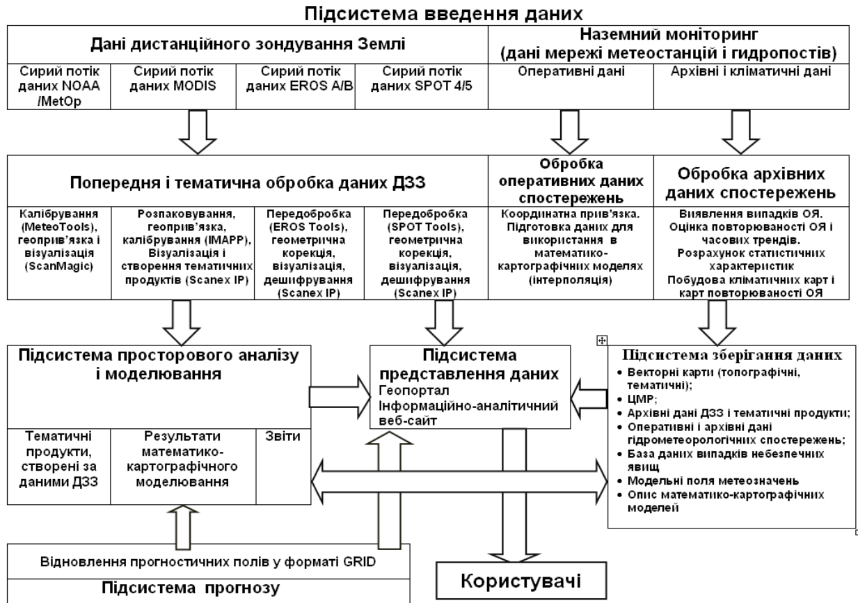
Рис. 7. Структура регіональної ГІС моніторингу та прогнозування НМЯ
