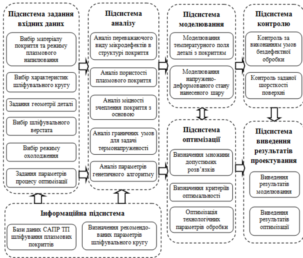
Рис. 3. Схема взаємозв'язків між модулями в САПР ТП шліфування плазмових покриттів
