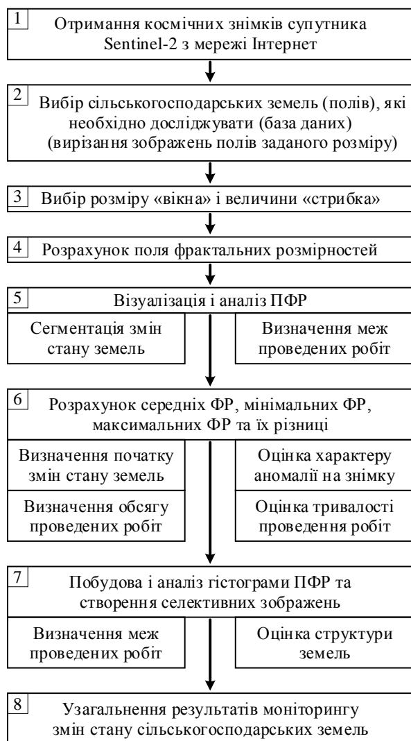
Рис. 13. Спрощена схема методу моніторингу змін стану сільськогосподарських земель з використанням фрактального аналізу
