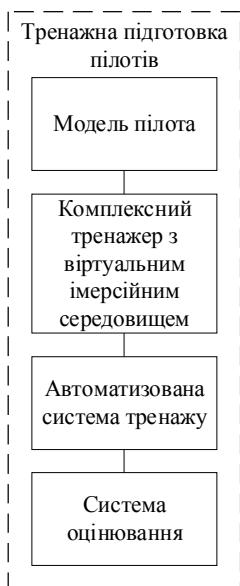
Рис. 2. Загальна структура тренажера підготовки пілотів цивільної авіації
