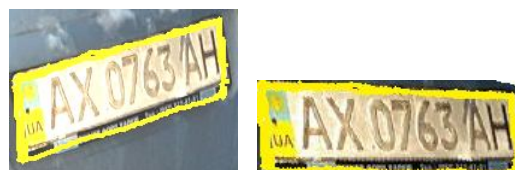
Рис. 5. Результат перетворення фрагмента зображення автономера у прямокутну область, придатну для подальшої сегментації і розпізнавання одиночних символів
