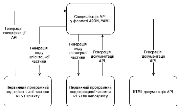
Рис. 3. Структура моделювання API, з визначеною специфікацією API
