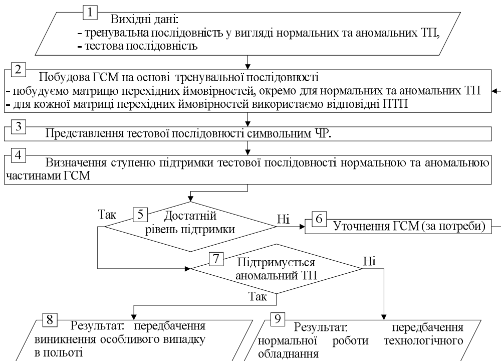
Рис. 1. Структура методу передбачення особливих випадків в польоті на основі завчасного виявлення аномальних послідовностей в діагностичних даних технологічного обладнання повітряного судна
