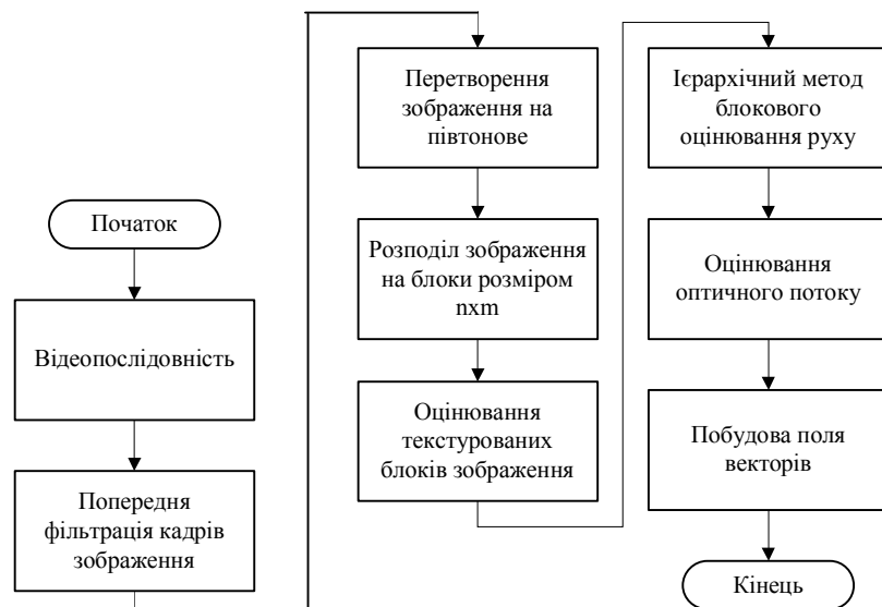
Рис. 12. Етапи методу визначення поля векторів руху з зважуванням вимірів блоків зображення
