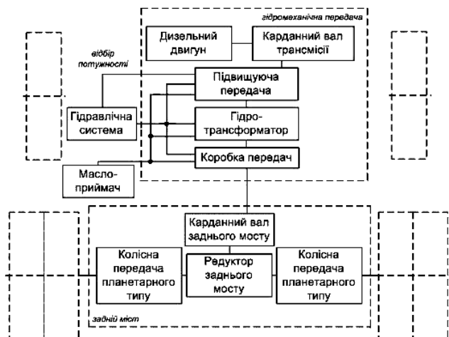
Рис. 1. Структурна схема гідромеханічної трансмісії з приводом на два колеса
