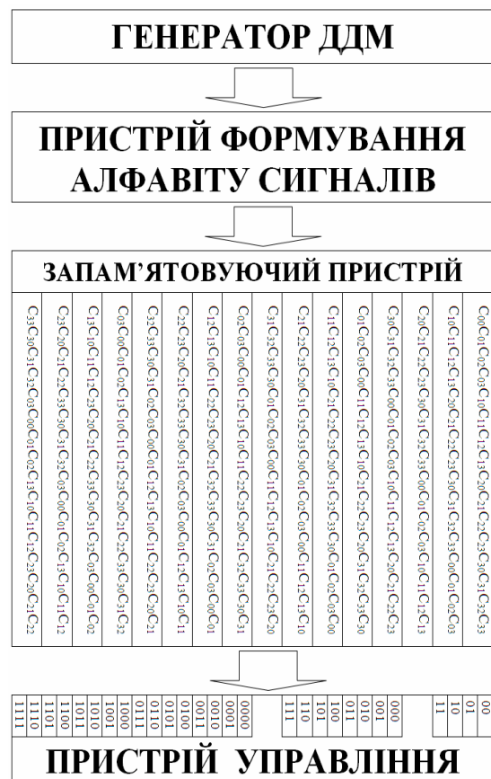
Рис. 2. Модель формування сигналів з адаптацією по швидкості передавання інформації на основі ДДМ
