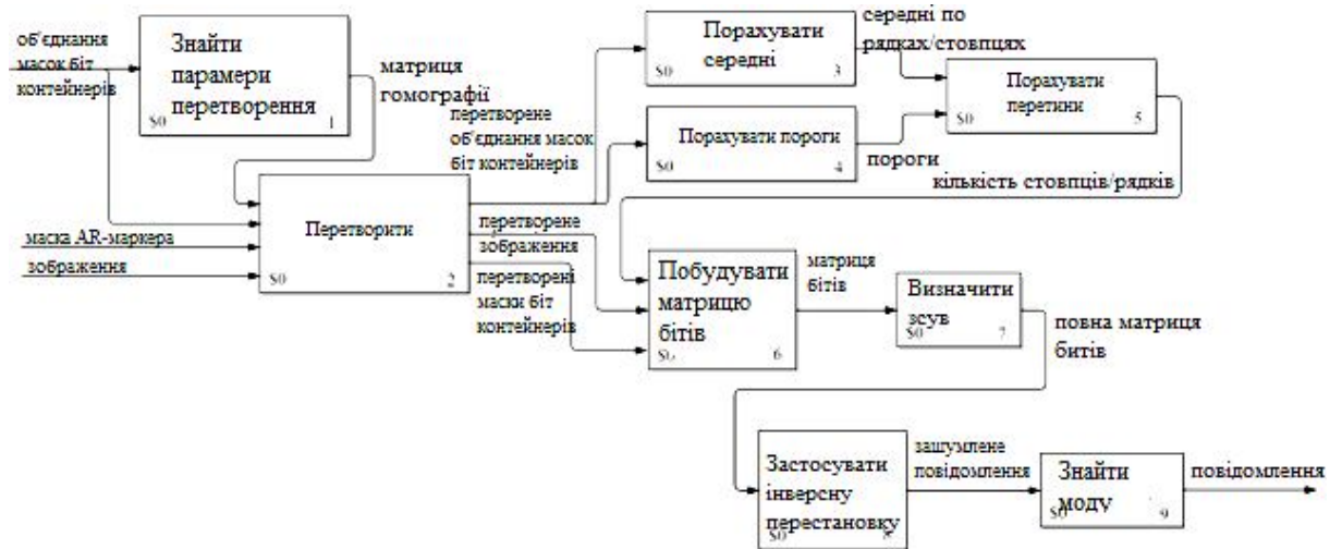
Рис. 10. Декомпозиція підпроцесу декодування повідомлення мозаїчного стохастичного маркера доповненої реальності
