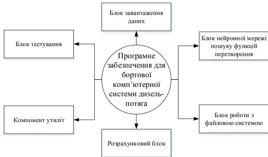
Рис. 3. Структура модулів програмного забезпечення для бортової комп'ютерної системи дизель-потяга
