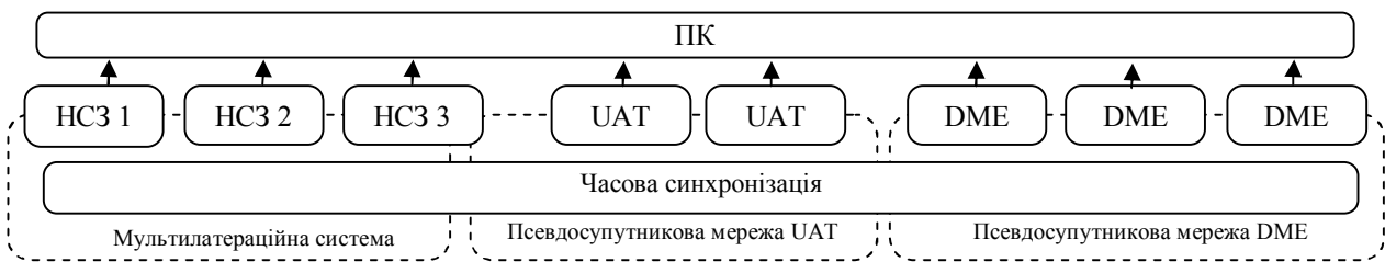
Рис. 4. Псевдосупутникова система позиціонування
