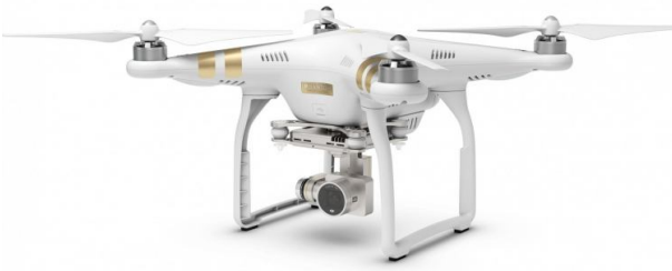
Рис. 3. Приклад квадрокоптера із зовнішньою підвіскою з курсовою камерою
