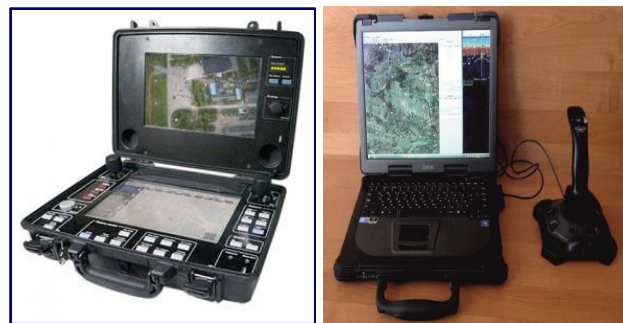
Рис. 1. Автоматизоване робоче місце оператора ДПЛА: а – система управління; б – засоби моніторингу
