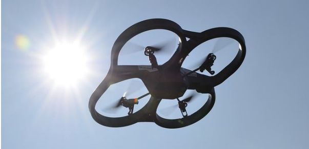
Рис. 4. Приклад конструкції БПЛА рамкового типу
