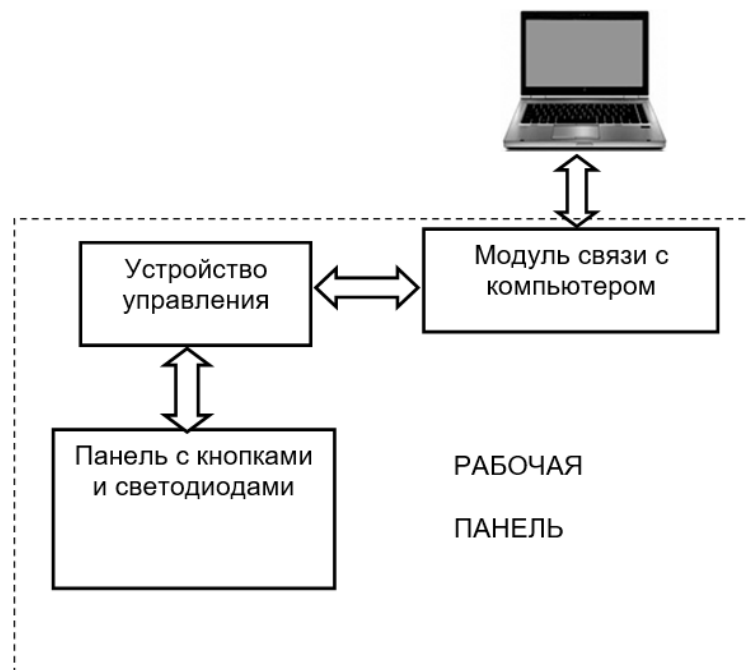
Рис. 1. Структура системы для определения времени сложной зрительно-моторной реакции
