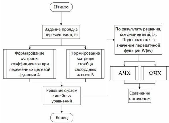
Рис. 2. Схема алгоритма моделирования расчета параметров ЦФ БИХ и оценки их характеристик
