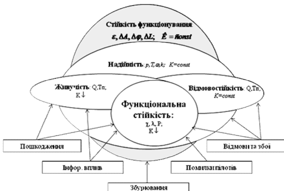
Рис. 1. Місце функціональної стійкості в системі властивостей складних технічних систем (за роботою [2])
