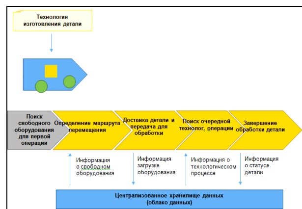
Рис. 2. Основные стадии обработки детали
