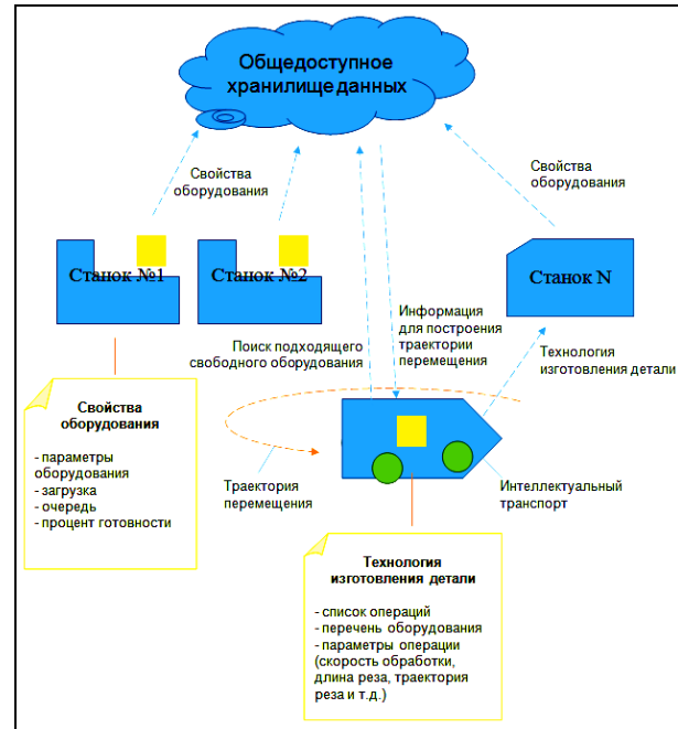
Рис. 1. Принцип взаимодействия между компонентами автоматизированной системы
