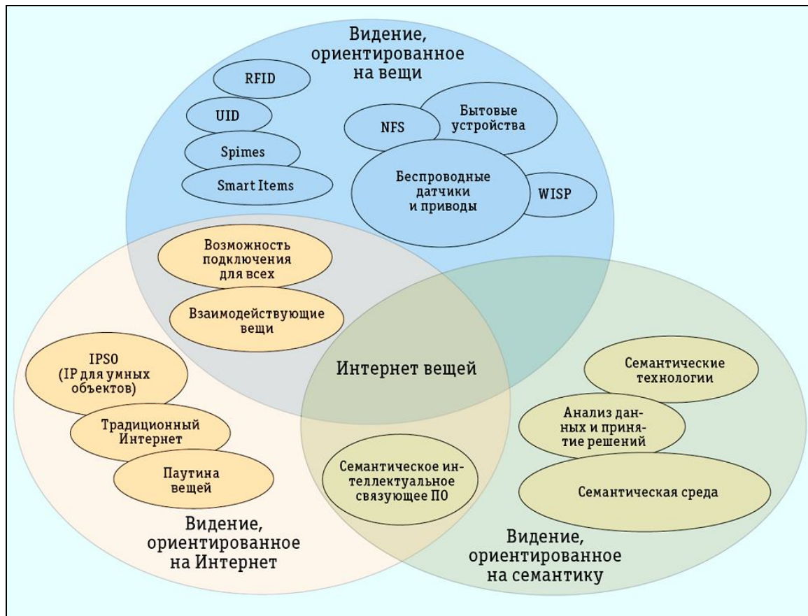
Рис. 1. Схема основных составляющих обобщенной концепции построения общей структуры IoT
