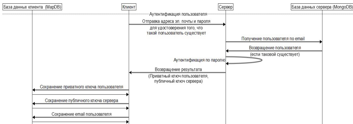
Рис. 2. Диаграмма последовательностей процесса аутентификации пользователя в системе
