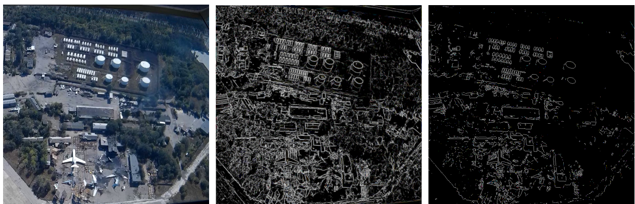
Рис. 1. Вихідне зображення [12] (а) та результати його сегментування еволюційним методом [10, 11] (б) та методом Канні (в)
