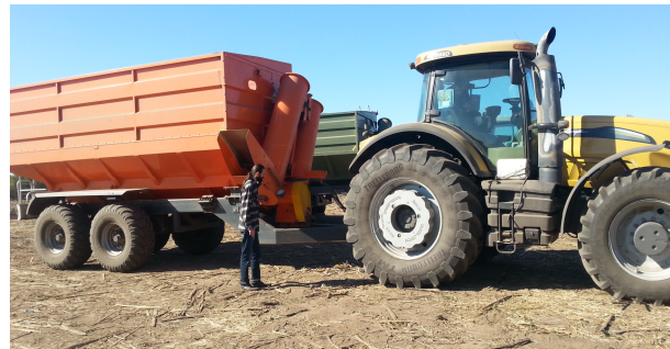
Рис. 3. Транспортно-технологічний агрегат Challenger MT685D + ПБН – 30 (транспортування насіння сояшника)
