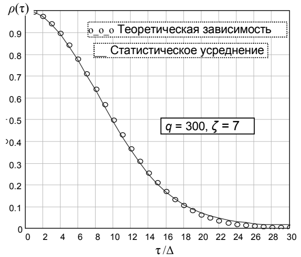
Рис. 1. Расчётная и теоретическая нормированные корреляционные функции ССП
