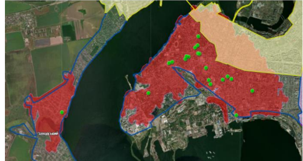
Рис. 5. Результат розрахунку зон покриття Центрального району до укриттів за типом снаряду «Шахед»
