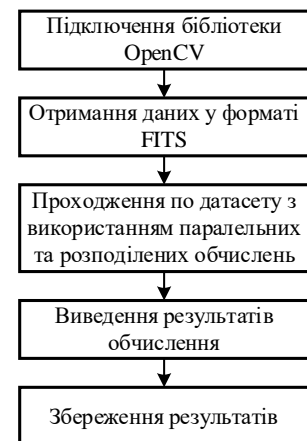
Рис. 1. Алгоритм роботи моделі, яка орієнтована на розподілені обчислення
