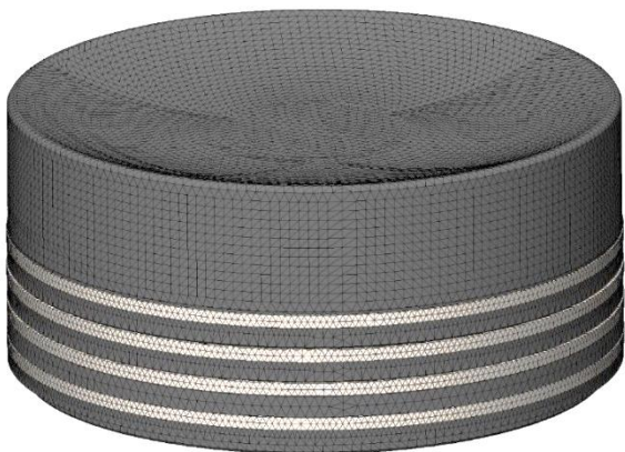
Рис. 2. Твердотільна модель головки поршня із пакетом поршневих кілець TriboPack
