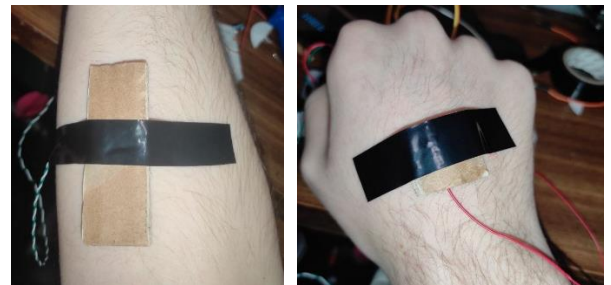
Рис. 12. Зображення електродів на руці користувача (а – контакти «+» та «-», б – контакт «REF»)
