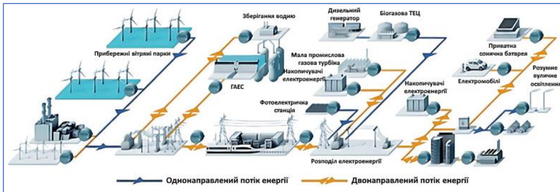
Рис. 1. Електричні мережі децентралізованої енергосистеми [12]
