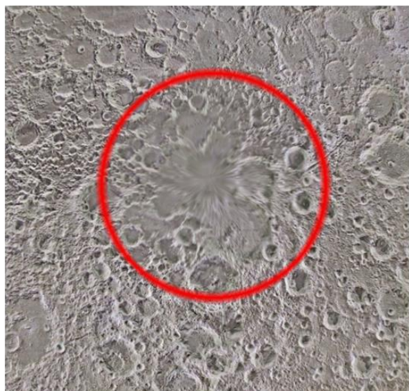
Рис. 7. Артефакти проєціювання при розрахунку текстурних координат для кожного фрагменту
