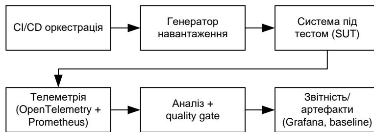
Рис. 1. Узагальнена архітектура автоматизованої системи тестування продуктивності
