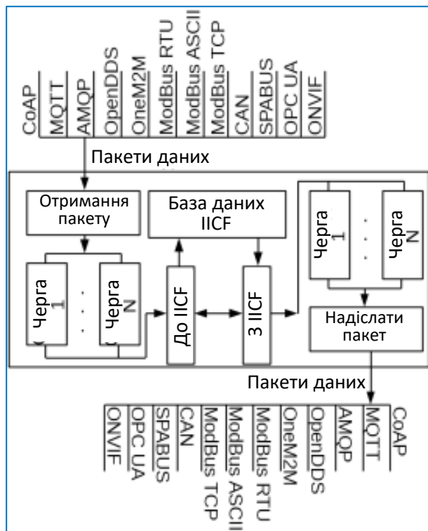
Рис. 2. Структура семантичного шлюзу IIoT
