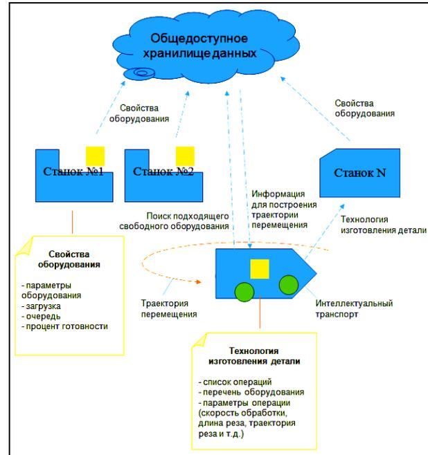
Рис. 1. Принцип взаимодействия между компонентами автоматизированной системы
