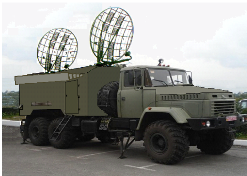
Рис. 2. Мобильная цифровая тропосферно-радиорелейная станция (конструктивный вариант 2)
