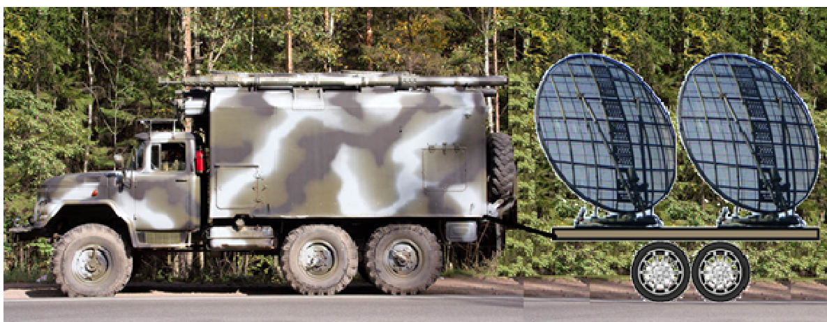
Рис. 1. Мобильная цифровая тропосферно-радиорелейная станция (конструктивный вариант 1)
