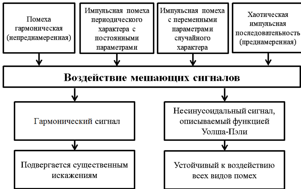
Рис. 6. Схема воздействия мешающих сигналов на полезный сигнал при проведении эксперимента
