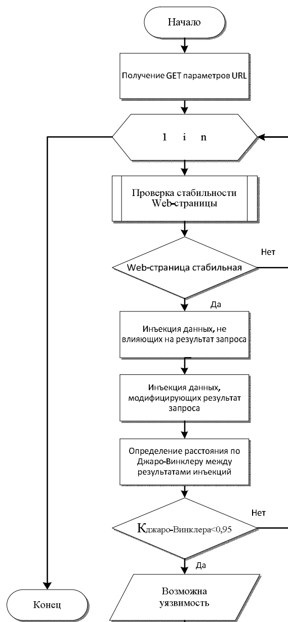
Рис. 1. Структурная схема алгоритма анализа уязвимости Web-приложения к SQL инъекциям
