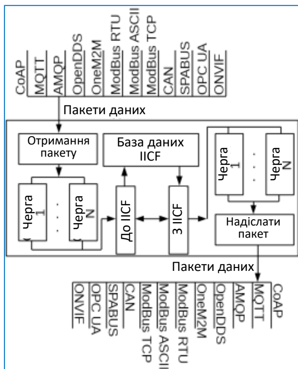
Рис. 2. Структура семантичного шлюзу IIoT
