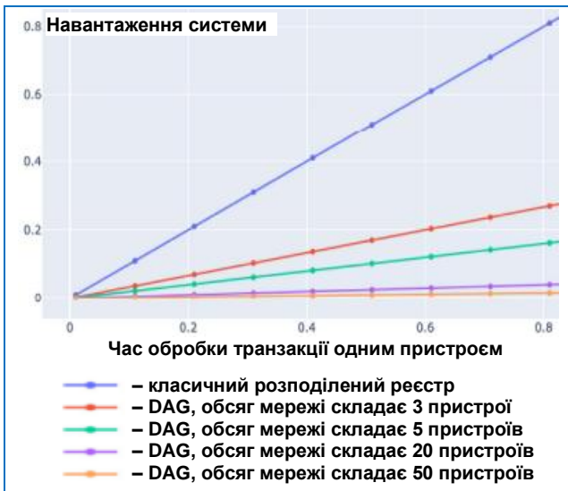
Рис. 4. Залежність завантаженості системи від середнього часу обробки транзакцій для розподіленого реєстру та ациклічного спрямованого графа з різною кількістю підключених пристроїв
