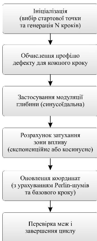
Рис. 1. Блок-схема алгоритму моделювання мікроподряпини
