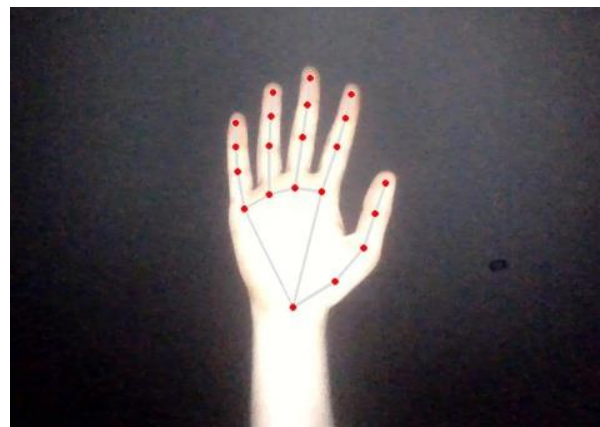
Рис. 2. Визначення 21 ключової точки ( landmark ) долоні й пальців
