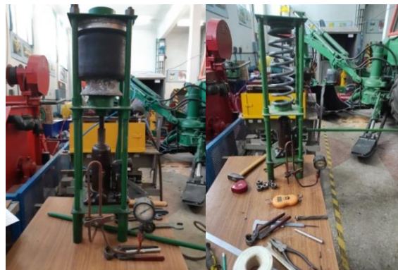
Рис. 5. Стенд для перевірки жорсткості пружних елементів
