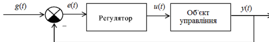
Рис. 1. Управління з негативним зворотним зв'язком
