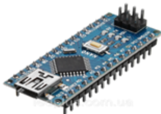
Рис. 3. Зображення платформи Arduino Nano
