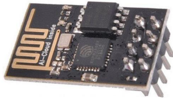
Fig. 7. Wi-Fi module ESP8266 version ESP-01
