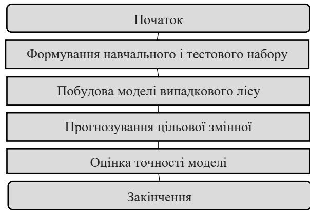
Рис. 1. Узагальнена структура методу побудови моделі прогнозування відмов навігаційних систем суден на основі випадкового лісу
