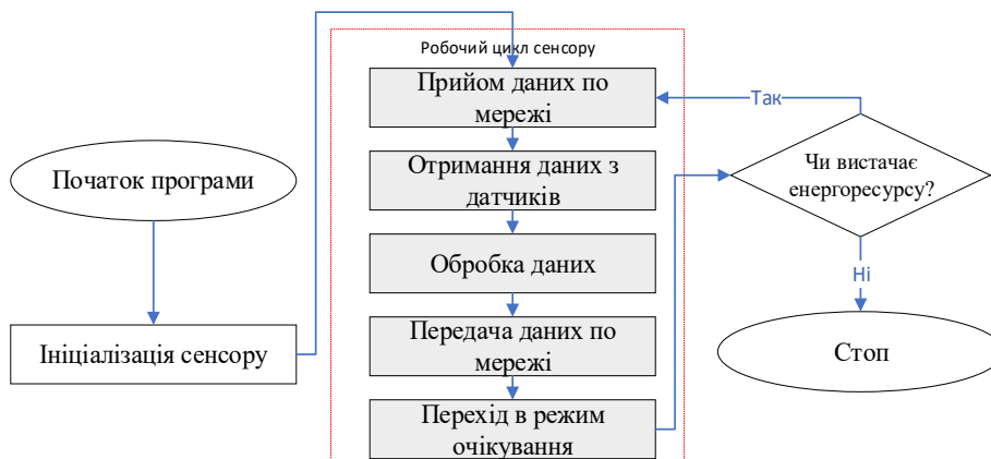
Рис. 2. Алгоритм роботи сенсора бездротової сенсорної мережі
