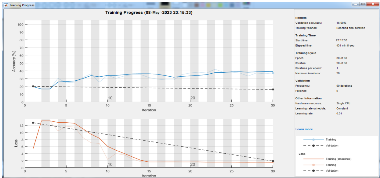
Рис. 8. ЗНМ навчальний запуск 1, з використанням центрального процесора. Точність перевірки 16% досягається за час навчання приблизно 431 хвилину
