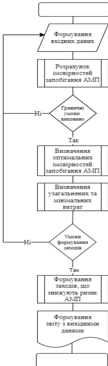
Рис. 1. Структура методу управління неприйнятними ризиками для визначення витрат на запобігання АМП і зниження можливих збитків від них у СУБС
