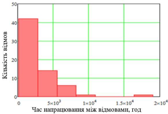
Рис. 4. Функція щільності розподілу ймовірності часу напрацювання між відмовами системи кондиціонування повітря
